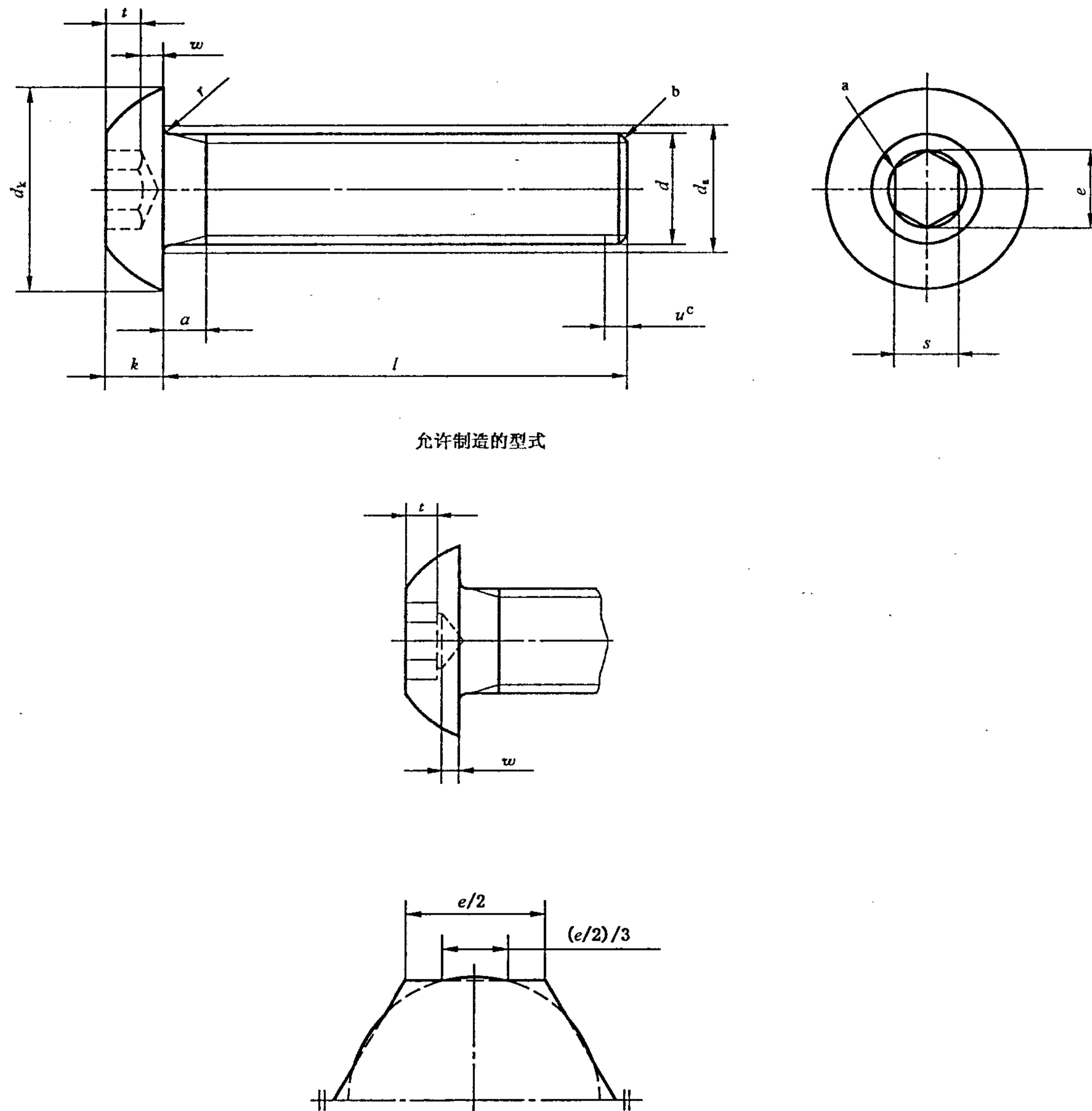
注：对切制内六角，当尺寸达到最大极限时，由于钻孔造成的过切不应超过内六角任何一面长度( $e/2$ )的1/3。
